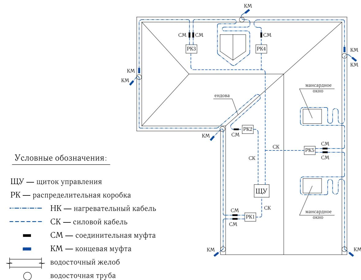
Рис. 3.5. Кабельная система обогрева кровли.
