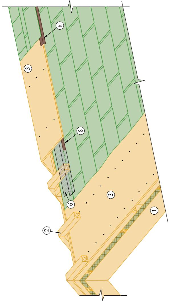
**Примечания:** 1. На торцы («фронтоны») вентиляционного конька рекомендуется устанавливать металлический фронтонный фартук S5, развертка 20 см;
