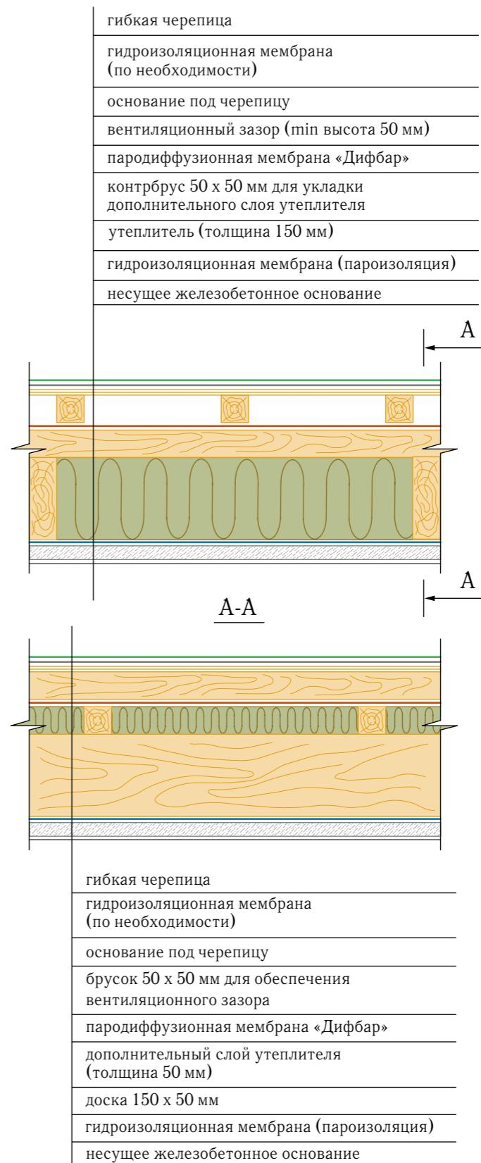
*Rис. 4.5.2. Крыша по железобетонному основанию*
