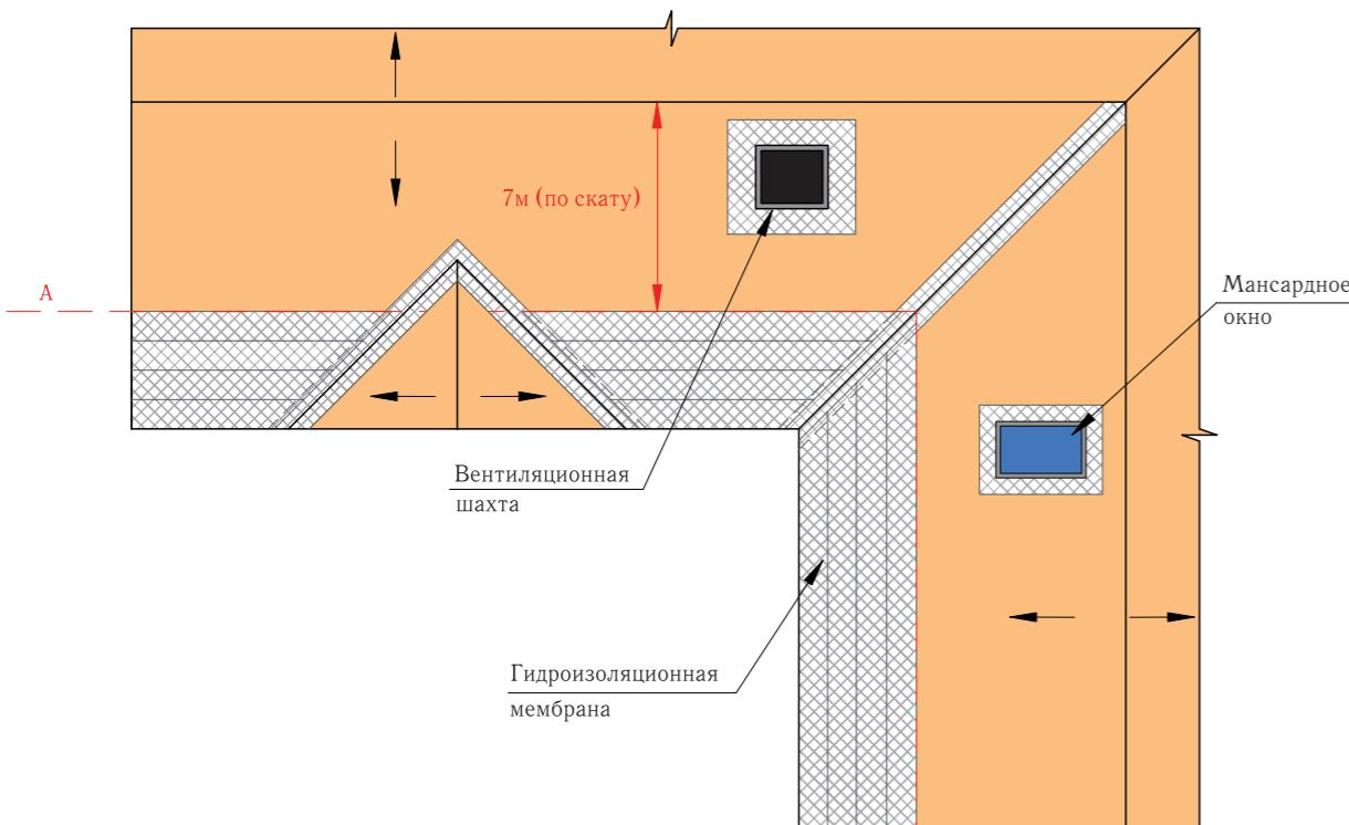
Рис. 4.16. Комбинированная гидроизоляция крыши
