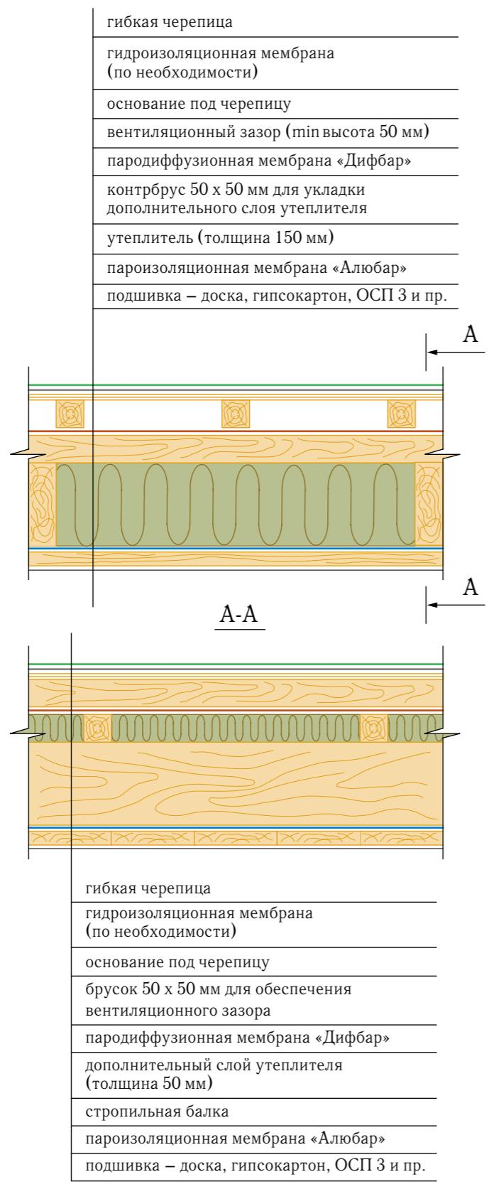
Рис. 4.3.2. Конструкция традиционной крыши мансарды
