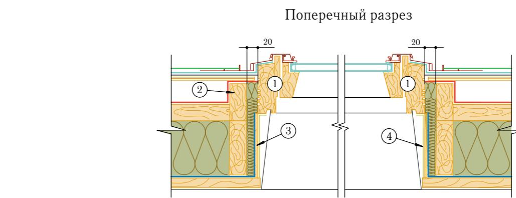
1 – дымовая труба из глиняного кирпича толщиной не менее 120 мм или из жаростойкого бетона толщиной не менее 60 мм (СНиП 41-01-2003, п.6.6.13);
