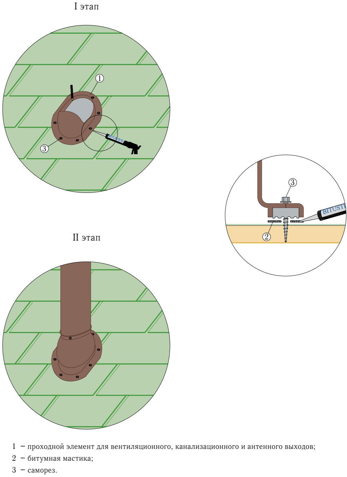
I этап: Установить проходной элемент на готовую кровлю и обрисовать по внутреннему контуру. Вырезать отверстие согласно обрисованному контуру. Промазать место установки элемента битумной мастикой.
