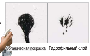
Органическая покраска Гидрофильный слой
