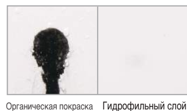
Органическая покраска Гидрофильный слой
