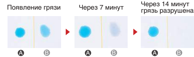
A Обычная панель B Панель с керамическим покрытием с фотокатализаторами
