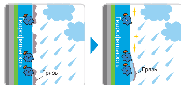
Капли дождевой воды проникают под грязь.
