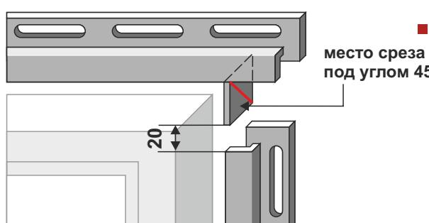
■ Стыки вертикальных и горизонтальных J-планок
