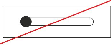
■ Устанавливаемую панель нужно сначала соединить с нижней панелью (или со стартовой полосой) и подтолкнуть вверх до защелкивания «замка». После этого панель можно прикручивать. При этом ее нельзя натягивать или сильно прижимать, она должна висеть на точках крепления без напряжения, сохраняя свою естественную форму. Сильное натяжение может стать причиной неправильного соединения с другими панелями и деталями. Избегать следует как излишне плотного крепления, так и болтающихся панелей.
