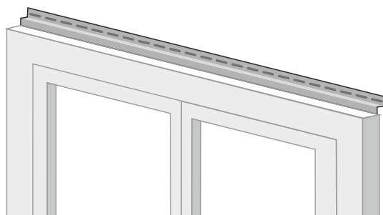
■ Схема установки J-планки вокруг оконного или дверного проемов
