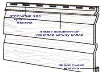
С одной стороны панели сайдинга имеют ряд отверстий для крепления к стене саморезами и выступ замковой части, обеспечивающий соединение панелей между собой. С другой - продольную кромку, загнутую вовнутрь, этот загиб и является ответной частью замка. Монтируют панели внахлест - сначала замковую часть верхней панели вводят в зацепление с выступом на нижней, а затем верхнюю панель крепят к обрешетке саморезами.
