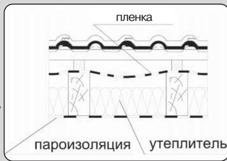
Укладку водозащитных пленок на утеплитель запрещена!
