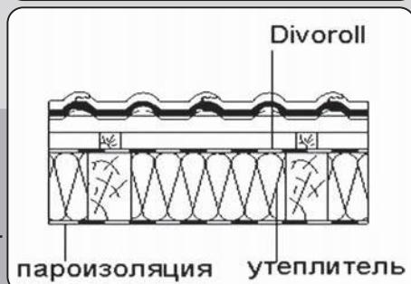
**Важно!** Между диффузионной мембраной и утеплителем не допускается неорганизованных глухих полостей. Мембрана должна лежать непосредственно на утеплителе.
