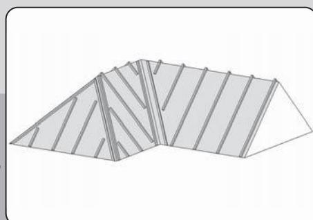
Схема устройства контробрешетки
